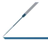
ベクターアレーは、大動物の脳深部へのアクセスを可能にしたプローブです。長さ 10 mm のシリコンシャングは生体適合性も高く、脳プローブに適しています。
