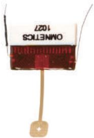
脳表に配置し ECoG をおよび頭蓋上に配置し EEG を記録するプローブです。生体親和性を保つようフィルムは適度に先行されています。パッケージはフレキシブルなリボンケーブルが付いた頭文字 H タイプです。
